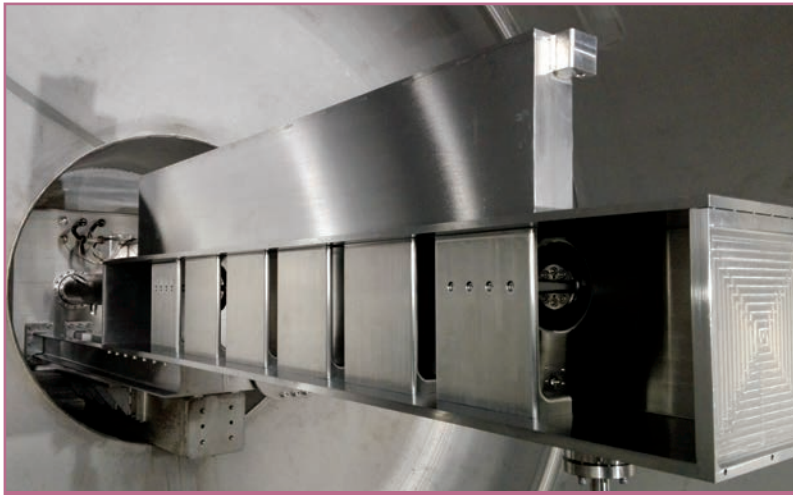
Figure 6 : Maquette forte puissance d'une antenne TWA pour l'ICRH, testée avec succès jusqu'à 2 MW sous vide à l'IRFM.
