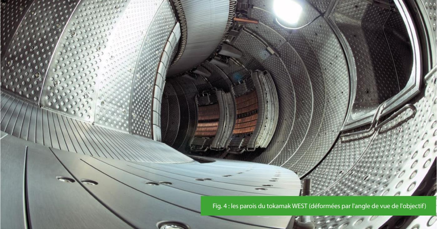
Fig. 4 : les parois du tokamak WEST (déformées par l'angle de vue de l'objectif)
