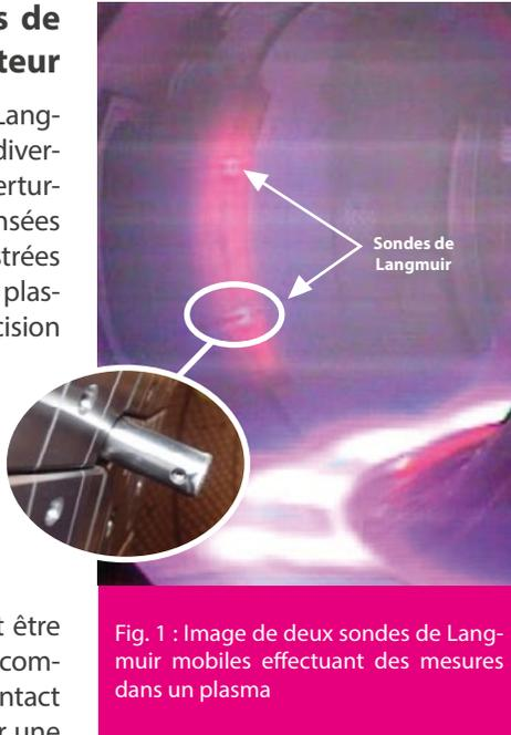
Fig. 1 : Image de deux sondes de Langmuir mobiles effectuant des mesures dans un plasma
