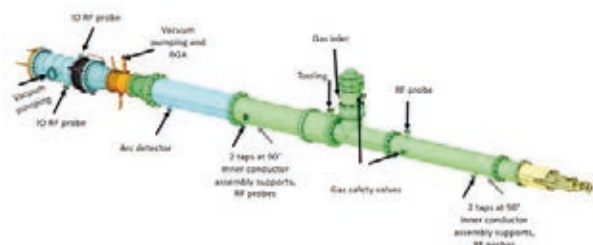
Figure 5: Vue de résonateur en configuration fenêtre avant et test en tension maximale
