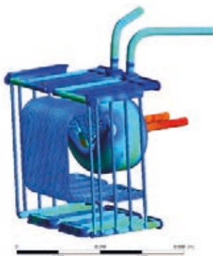
Figure 6: Ensemble des canaux de refroidissement du strap.
