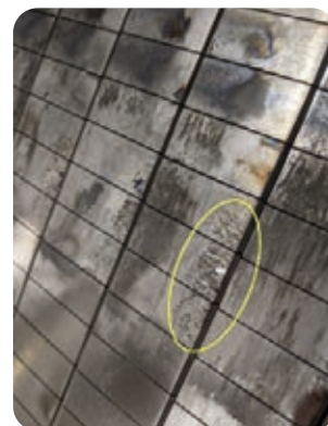
Figure 5 : Inspection visuelle du divertor de technologie ITER après la campagne « forte fluence ». À gauche : photo du secteur Q4A du divertor (PFU 1 à 19), montrant les principales caractéristiques observées après la campagne « forte fluence ». La position du point d'interaction extérieur/intérieur pendant cette campagne est indiquée (OSP/ISP respectivement), ainsi que la position des zones ombragées par les biseaux. Les dépôts épais sur le côté à haut champ (HFS) sont également indiqués. À droite : zoom sur les dépôts de type « feuille mince » trouvés dans les zones ombragées par le biseau toroïdal des éléments de technologie ITER.
