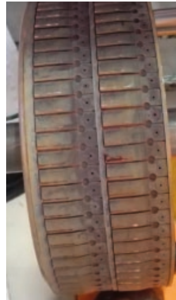
Figure 3: Contacts RF après test à 1.5 kA/3600 s
