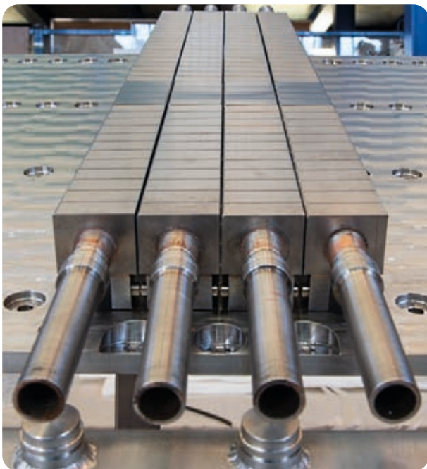
Figure 3 : éléments du divertor activement refroidi de WEST. Chaque élément dit « plasma facing unit / PFU » est équipé de 35 monoblocks de tungstène. Le divertor de West comprend 456 PFU. Les différences de luminosité reproduisent les formes, biseaux et inclinaisons variables des monoblocks.
