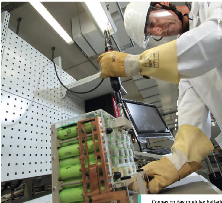
Connexion des modules batterie
