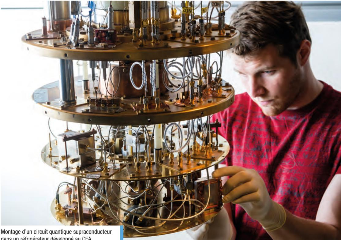
Montage d'un circuit quantique supraconducteur dans un réfrigérateur développé au CEA.
