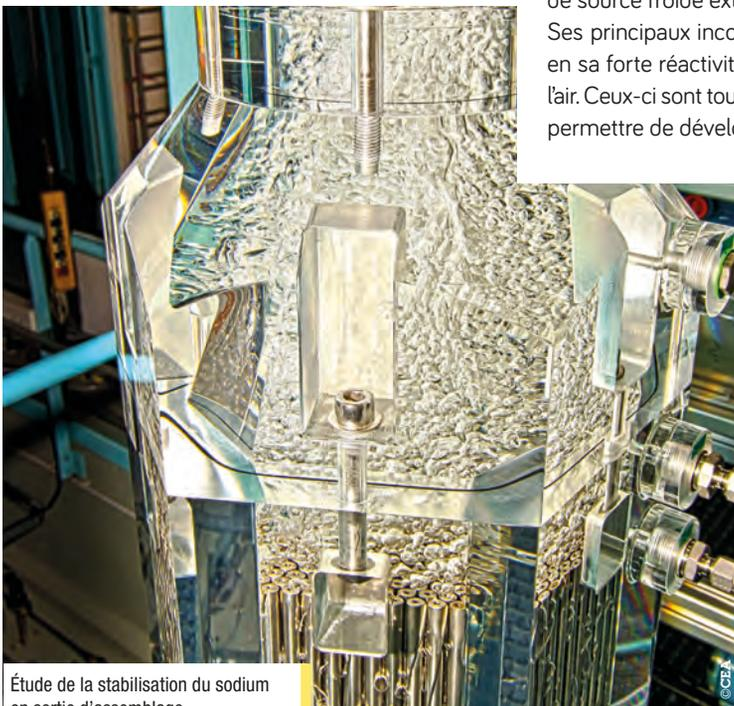
Étude de la stabilisation du sodium en sortie d'assemblage.
