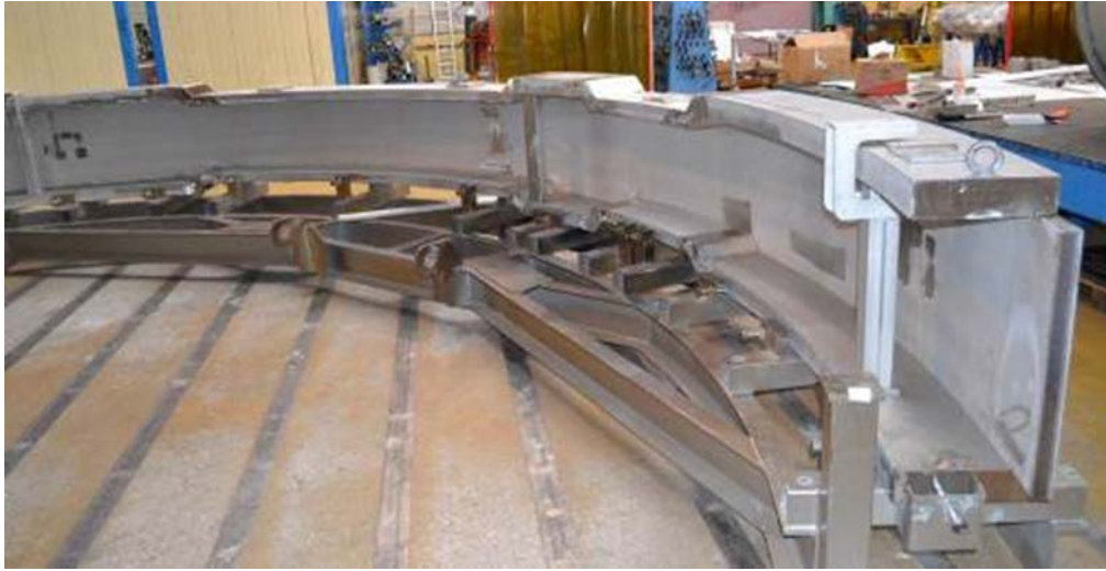
1ère structure de liaison interbobine en cours de fabrication (septembre 2014)
