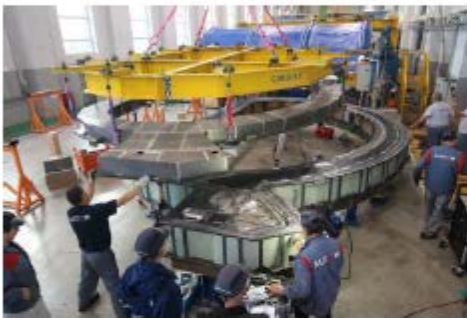
JT60SA - TOKAMAK Bobines de champs Toroidal en cours de fabrication - 5,2 Tesla - 20 Tonne
