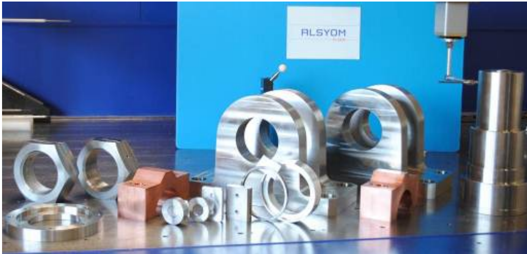
Composants élémentaires d'un pied support avant soudage sur les tubes de liaison
